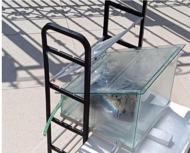
Figura 1. Primera versión de destilador utilizando lente Fresnel
