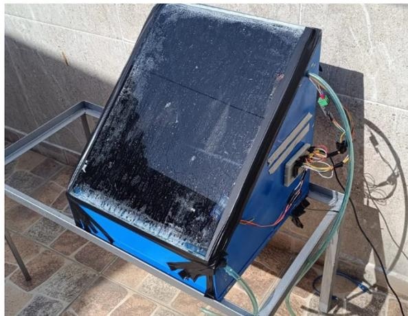
Figura 4. Diseño final del sistema de monitoreo del destilador solar a través de IoT
